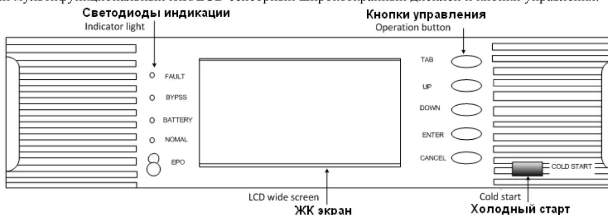
Рисунок 3.1 Интерфейс мониторинга (панель управления)
