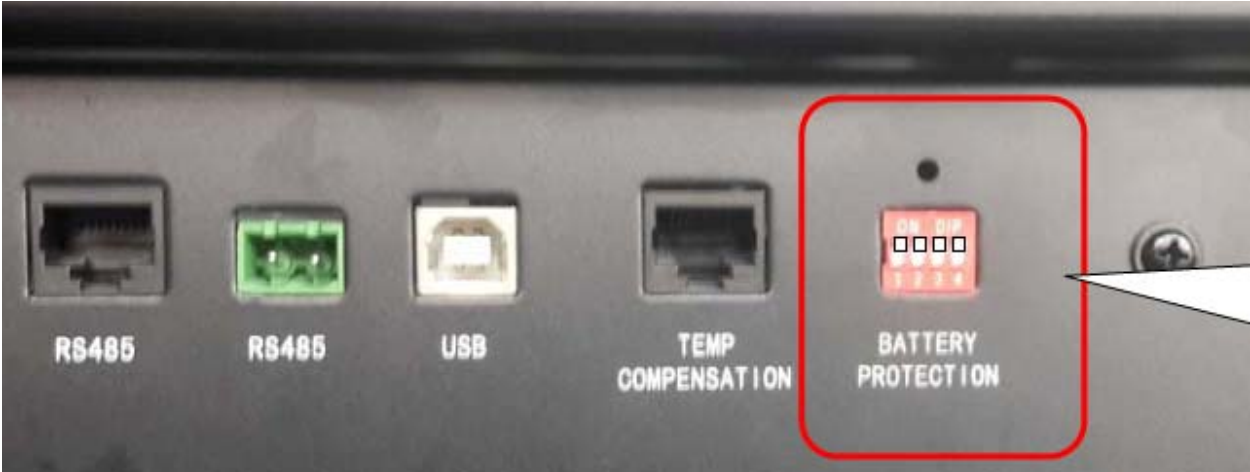
Рисунок 3 DIP-переключатель числа батарей.
